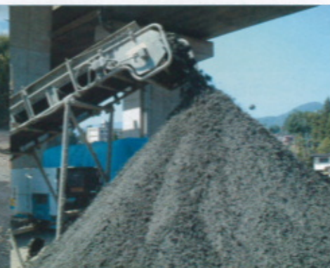
高含水比の泥水を数分で粒状固化し、コンベアーでの搬送がスムーズに。
