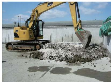
写真9. 放射性汚泥固化実験(平成25年4月15日~17日 信濃川浄水場ストックヤード) 左上:放射性汚泥の保管状態 右上:浄水場の固化材添加状態 左下:浄水発生土の天日乾燥プール 右下:同・固化材攪拌混合実験
