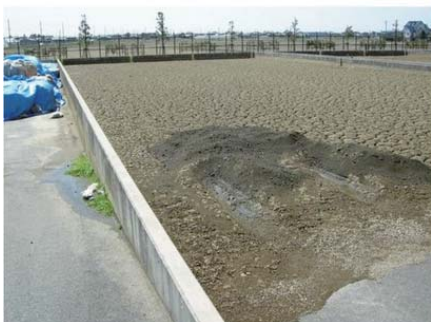
写真9. 放射性汚泥固化実験(平成25年4月15日~17日 信濃川浄水場ストックヤード) 左上:放射性汚泥の保管状態 右上:浄水場の固化材添加状態 左下:浄水発生土の天日乾燥プール 右下:同・固化材攪拌混合実験
