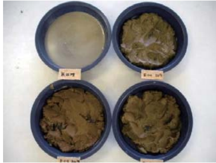
写真1. 生コンスラッジの中性化処理 左上：生コンスラッジ(原泥) 右上：AC-096 50kg/m 3 添加品 左下：AC-096 100kg/m 3 添加品 右下：AC-096 200kg/m 3 添加品
